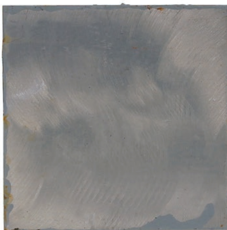
Powierzchnia zabezpieczona 3M™ Cavity Wax Plus 08852 (3 warstwy)
